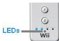
Figura 1.2: Led indicanti il numero di colpi disponibili nel caricatore
