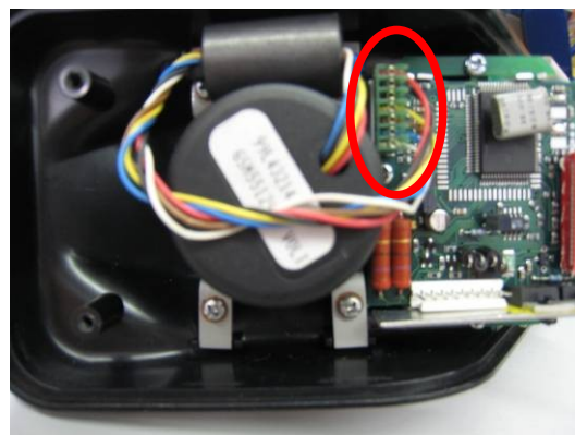
Illustrazione 2: Interno del Joystick della carrozzina, in rosso evidenziato il connettore della leva
