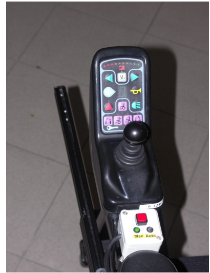
Illustrazione 3: Il joystick della carrozzina e il pulsante per il cambio della modalità di funzionamento del circuito con i due led di segnalazione
